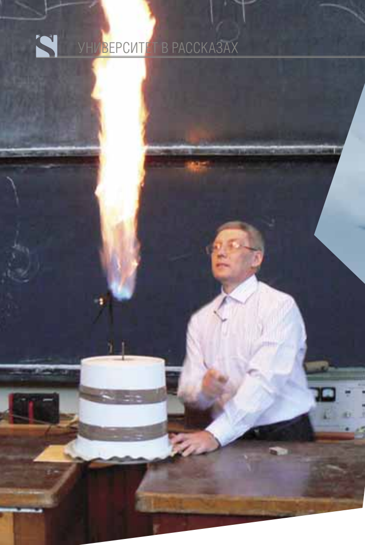
А это тушение кольцевым вихрем пламени газового фонтанчика. Доли секунды – и «авария» ликвидирована!
